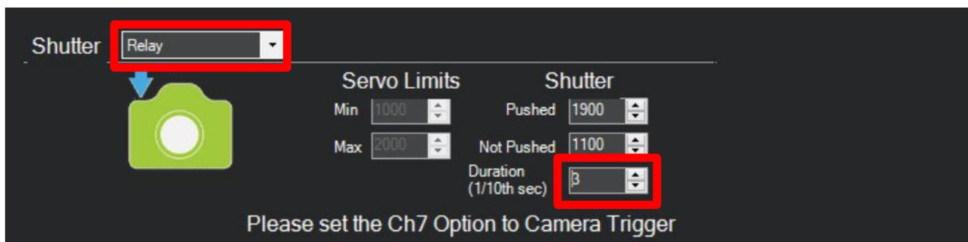
On y règle le type de déclenchement sur « Relay » pour avoir une pulse de commande (mode I/O) et une durée de pulse de 3/10 de seconde.
