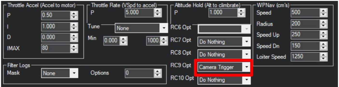
On y règle RC9 sur « Camera Trigger » puisque notre inter radio pour le DROP est en voie 9.
